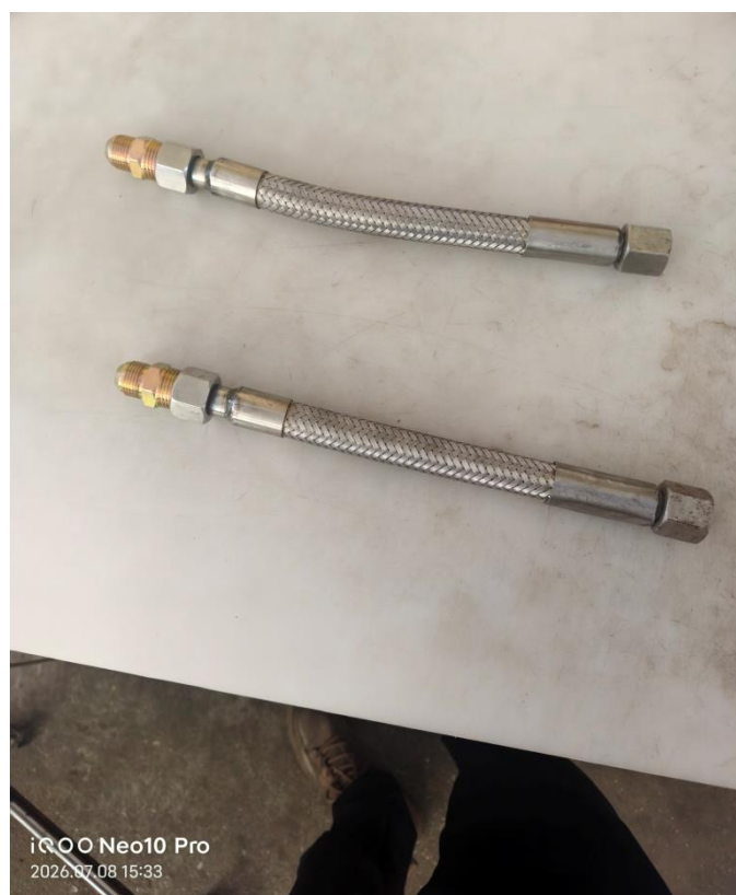
附图 6.3-2 已采购压力软管，待检维修时更换
